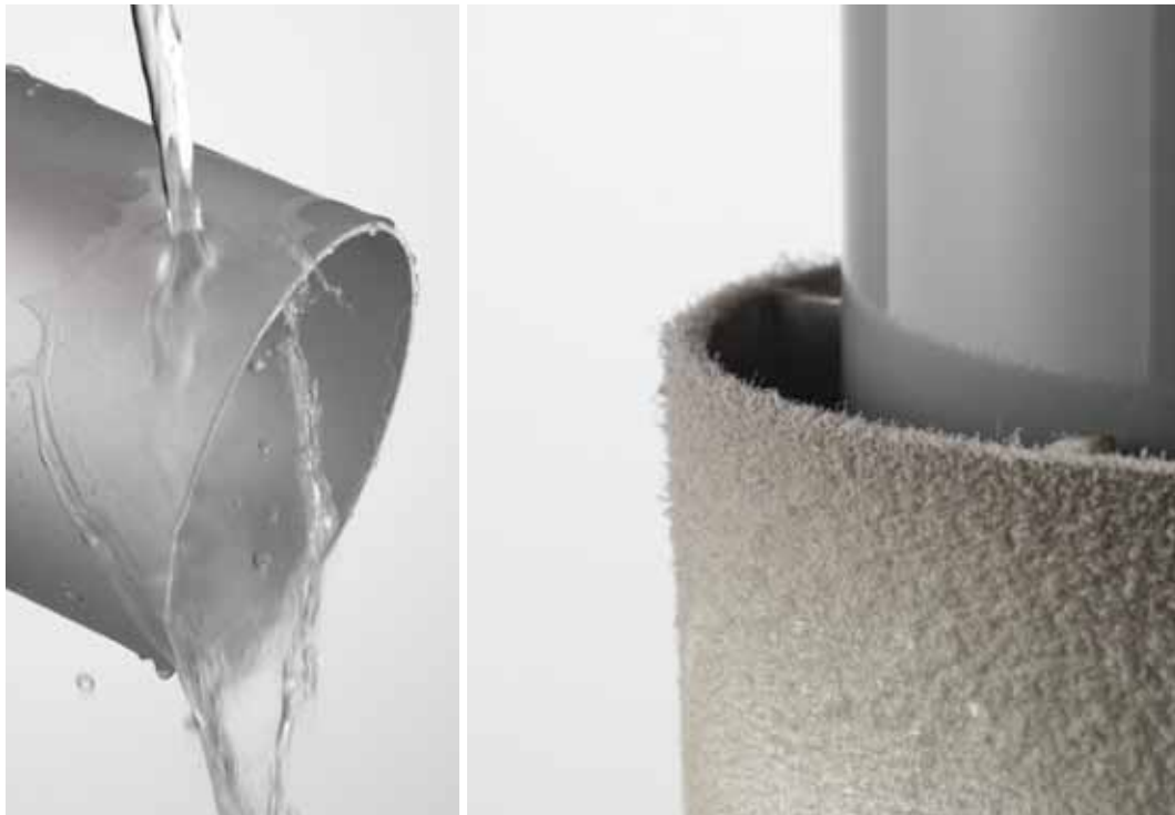
Présentation d'un collecteur propre (sous le jet du robinet) et d'un sale, après deux semaines d'utilisation dans un appartement du centre de Stockholm (Suède).
